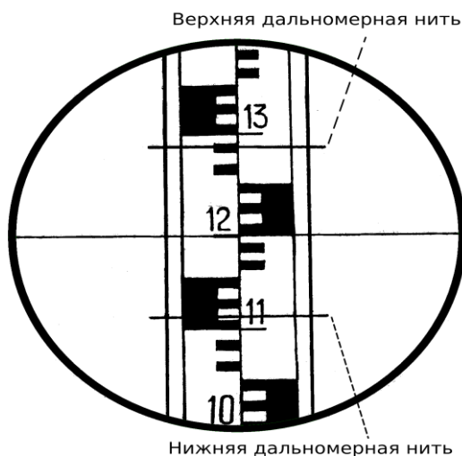
Рис. 25. Изображение рейки и сетки нитей в зрительной трубе
