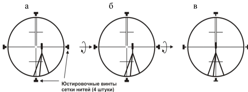
Рис. 8. Юстировка для устранения коллимационной ошибки
