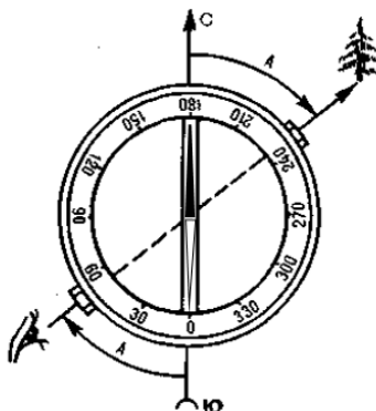
Рис. 33. Техника измерения магнитного азимута
